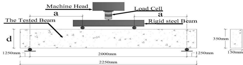
Fig. 3 Test Setup
